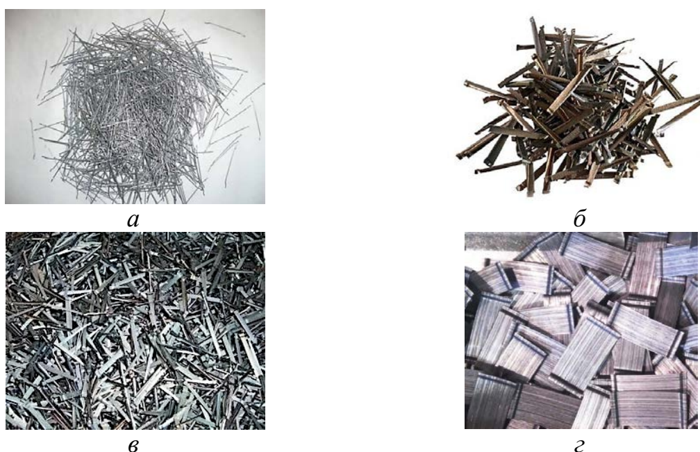
Рис. 3.4. Внешний вид стальной фибры: а — стальная фибра проволочная; б — стальная фибра из шлаков; в — стальная фибра листовая; г — стальная пакетированная фибра Драмикс
